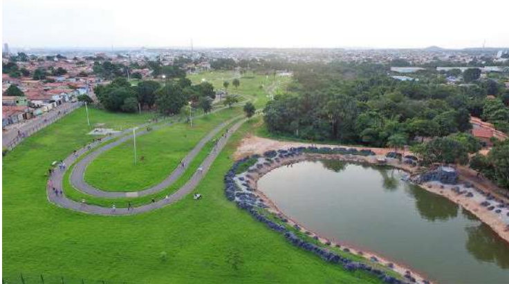
Figura 70: Exemplos de reservatório de drenagem
