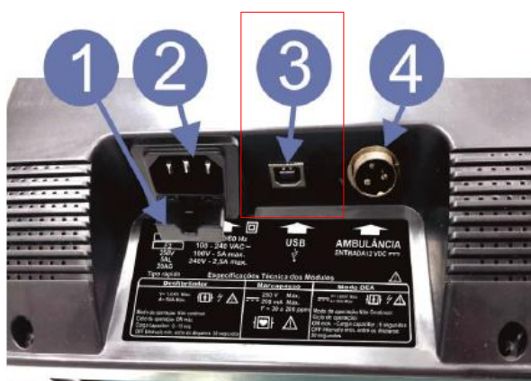
Figura 5 – Entradas de alimentação e comunicação.
