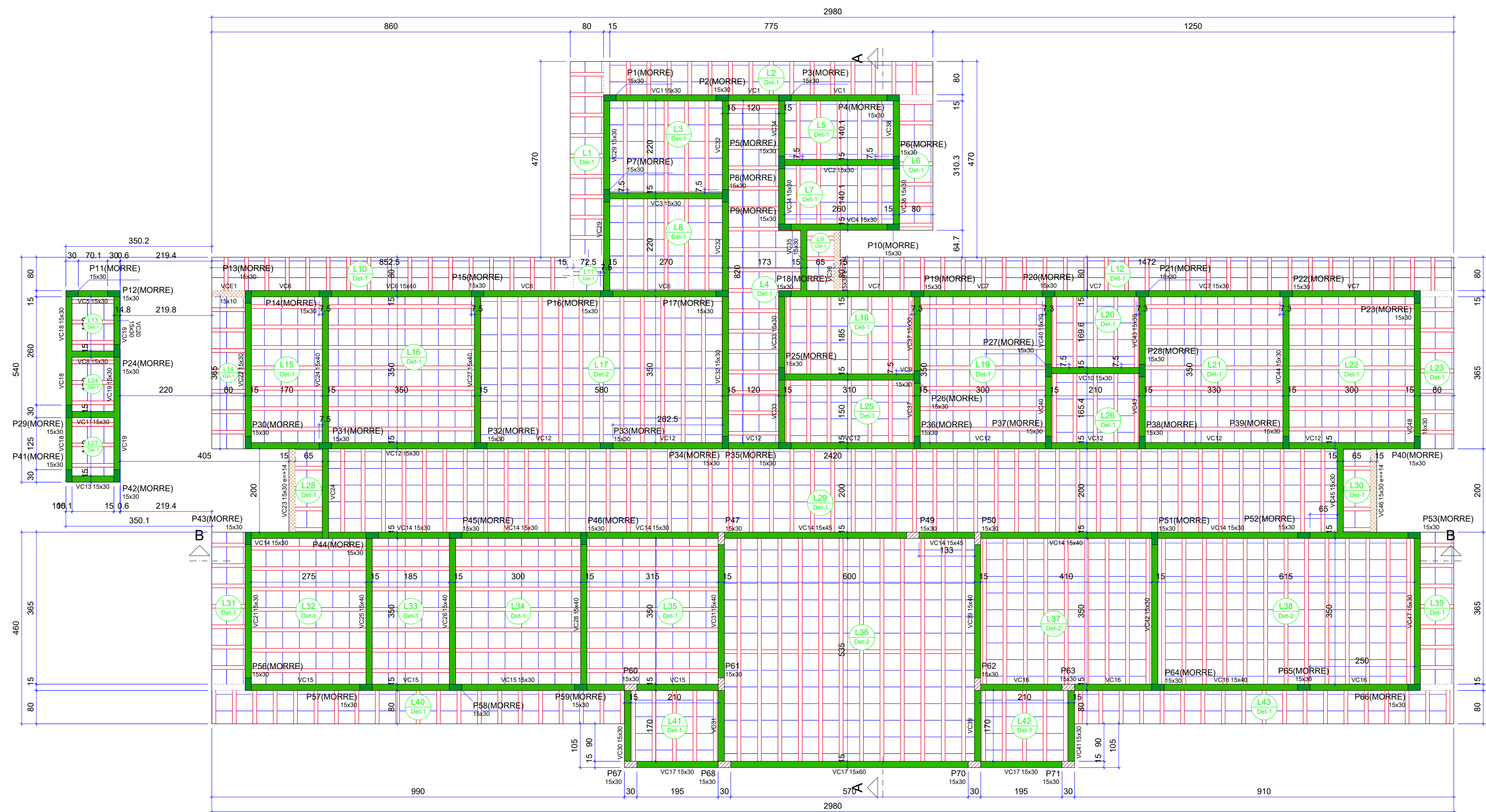
Forma do pavimento COBERTURA (Nível 290) escala 1:50
