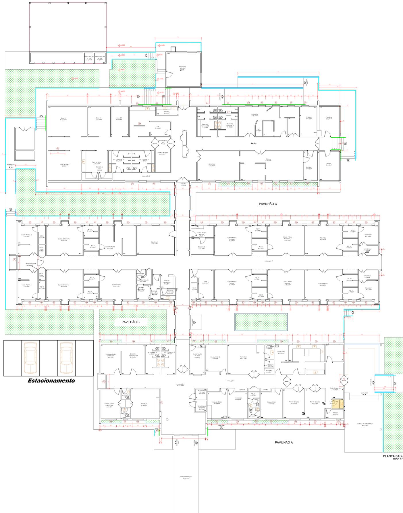
\*TODAS AS EQUADRIAS DO PERÍMETRO DO HOSPITAL SERÃO TROCADAS POR VIDRO TEMPERADO. A ÚNICA PARTE DE DEMOLIÇÃO SERÁ A RETIRADA DAS EQUADRIAS METÁLICAS;
