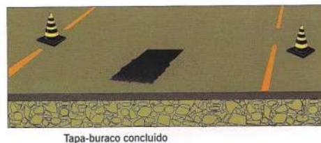
Figura 2.6 – Etapas de execução de um remendo profundo (continuação).
