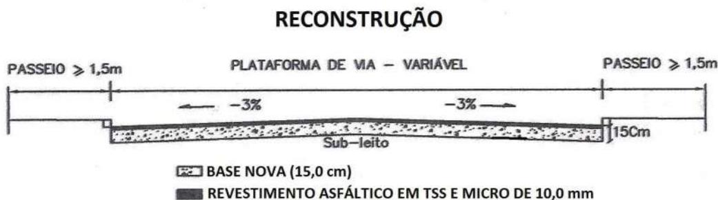
Figura 2.3 – Seção tipo de reconstrução
