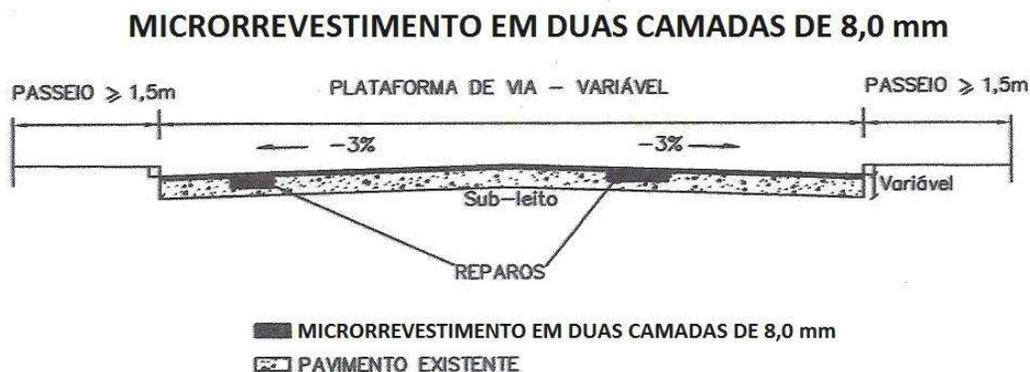
Figura 2.1 – Seção tipo de aplicação microrrevestimento
